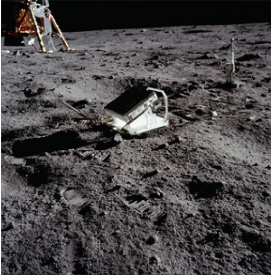
Le coin de cube déployé par Aldrin (Apollo 11). 60 cm de côté ; 100 miroirs
